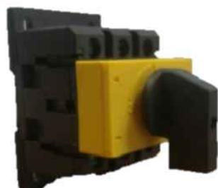
A chave seccionadora tripolar e tetrapolar de alta capacidade de ruptura é provida de contatos de pressão com dupla abertura simultânea que garante maior segurança na operação. O mecanismo de abertura e fechamento rápido garante que a velocidade e força das operações independam da ação do operador.
