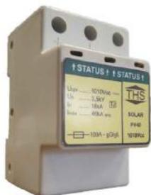
O DPS é o dispositivo que diminui os efeitos da sobretensão no circuito. A função do DPS na String Box é de proteger o inversor contra sobretensões vindas do circuito CC. Os fenômenos que podem causar as sobretensões são: descargas atmosféricas no sistema SPDA e descargas atmosféricas próximas que induzam corrente no circuito CC.
