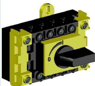
A chave seccionadora NPV tem como objetivo interromper a passagem de corrente elétrica, ou seja, a capacidade de seccionar um circuito elétrico onde tem uma carga específica que possui a necessidade de interrupção seja por manutenção, troca de equipamento ou outros fatores. Para a aplicação fotovoltaica é necessário a utilização de uma chave que suporte um alto nível de tensão em CC e os arcos resultantes do seccionamento.
