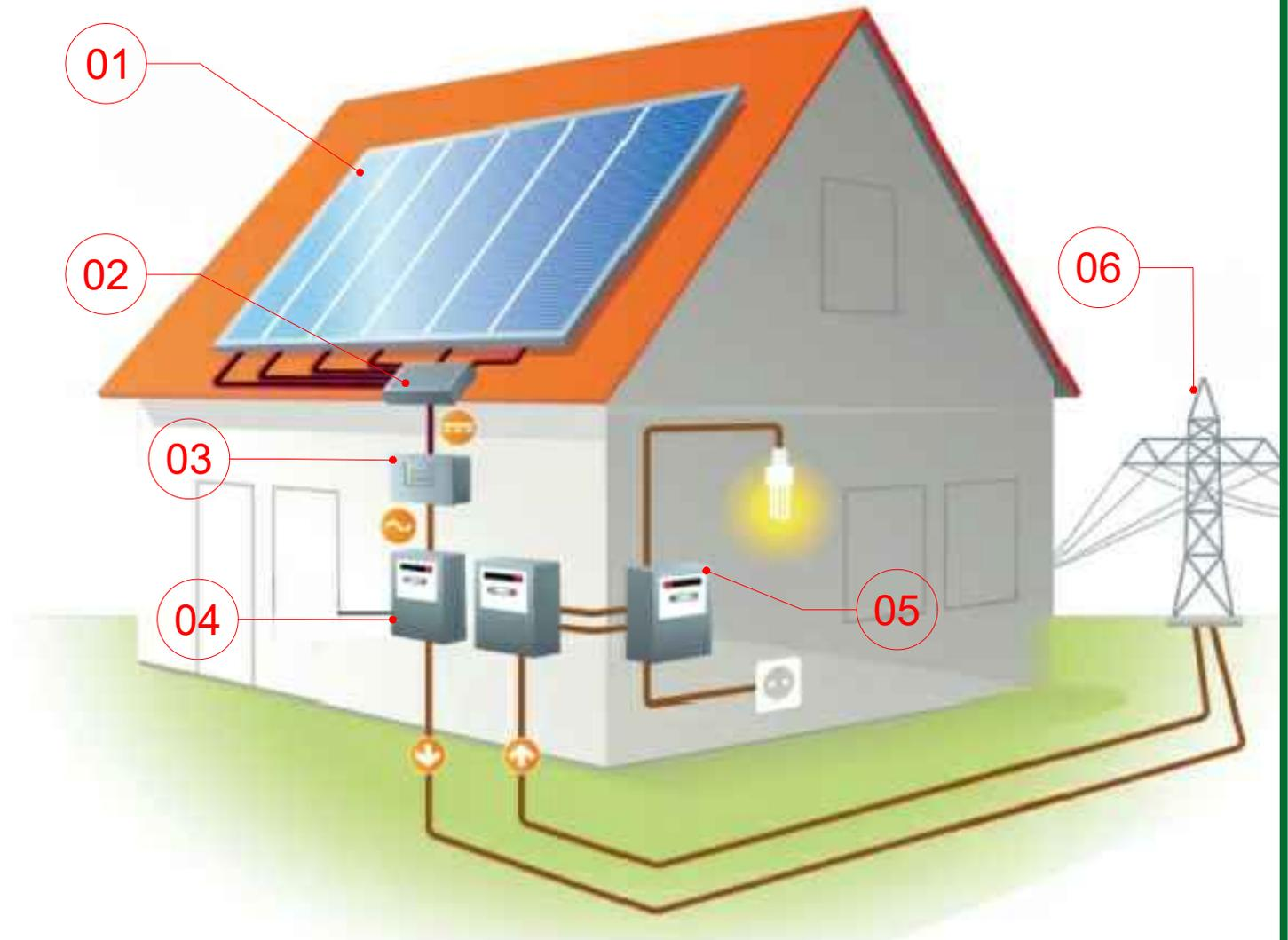
1 - Painéis Solares: Placas com células fotovoltaicas, que convertem a luz solar em energia elétrica.
